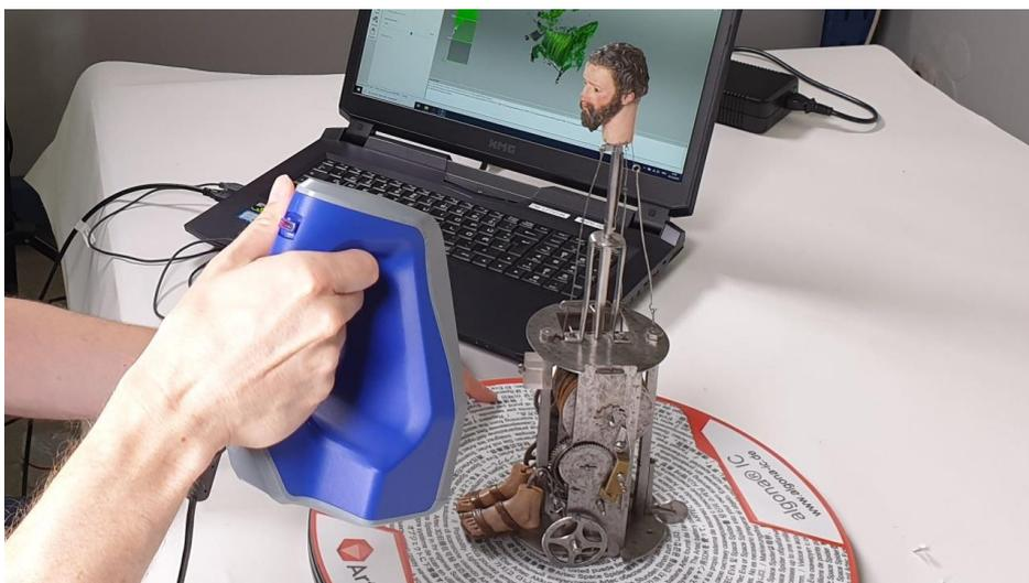
Abbildung 10: handgeführter Streifenlichtscanner, Foto: Deutsches Museum Digital, CC BY-SA 3.0
