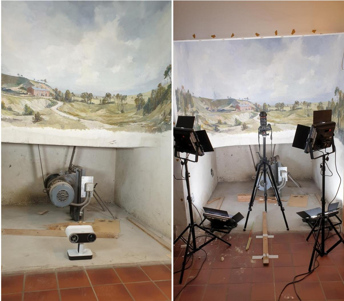
Abbildung 52: 3D-Scan eines Diorama-Hintergrundes, Vergleich Artec Leo vs. Photogrammetrie / Foto: Deutsches Museum Digital, CC BY-SA 3.0
