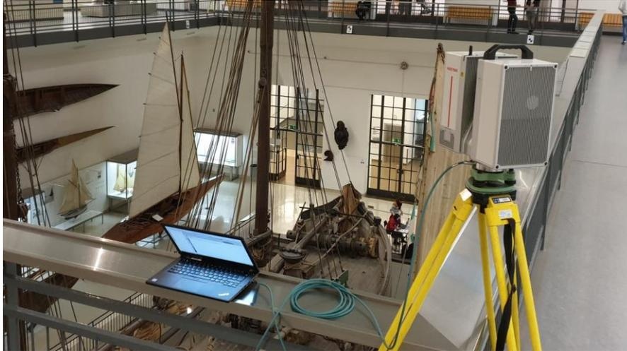
Abbildung 1: LIDAR-Scanner im Einsatz, Foto: Deutsches Museum Digital, CC BY-SA 3.0
