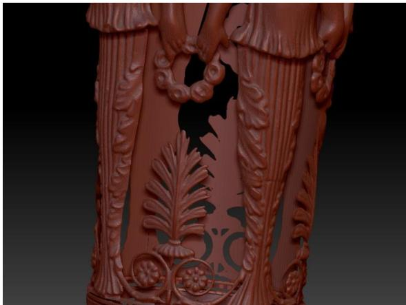
Abbildung 56: Ansicht nach Subtraktion des Drehkörpers vom Scanmodell in ZBrush / Screenshot: Deutsches Museum Digital, CC BY-SA 3.0
