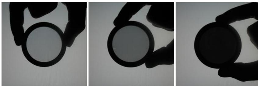
Abbildung 15: Polarisationsfilter in verschiedenen Stellungen, Quelle: Wikimedia, Public Domain
