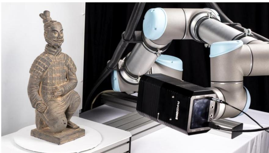
Abbildung 12: Photogrammetrie unterstützt durch Roboterarm, Foto: Fraunhofer IGD
