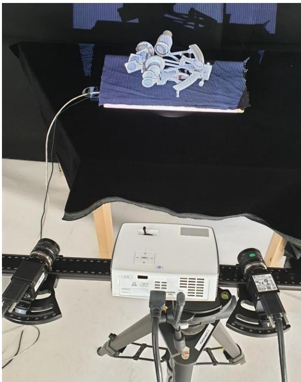
Abbildung 9: Stationärer Streifenlichtscanner, Foto: Deutsches Museum Digital, CC BY-SA 3.0
