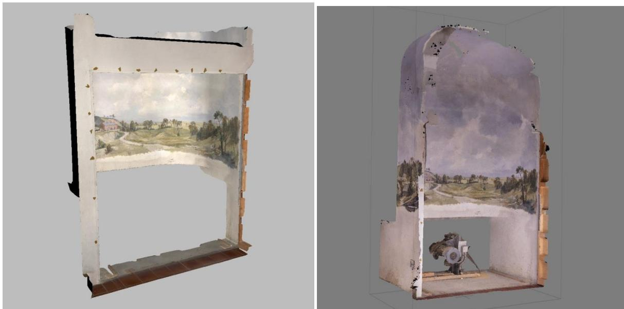
Abbildung 53: Scan-Ergebnis, links: Artec Leo, rechts: Photogrammetrie mit Agisoft Metashape Screenshot: Deutsches Museum Digital, CC BY-SA 3.0
