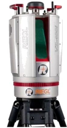
Aktives Messen per ToF, z.B. Laserscanning mit Riegl VZ400i
